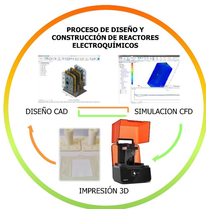
Figura 1. Proceso de desarrollo y fabricación de reactores electroquímicos para procesos de oxidación avanzada mediante diseño CAD, simulación CFD e impresión 3D.
