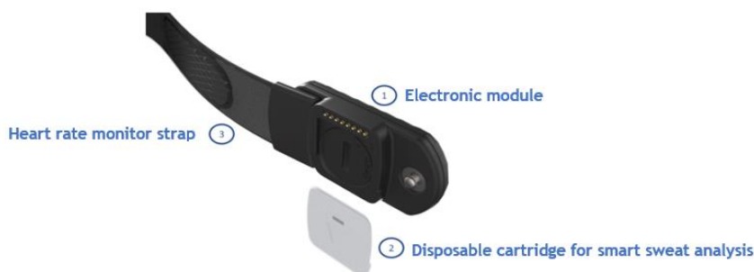
Figura 1. Esquema del funcionamiento del dispositivo.
