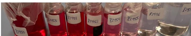
Figura 6. Evolución de la decoloración con el tiempo de electrólisis.
